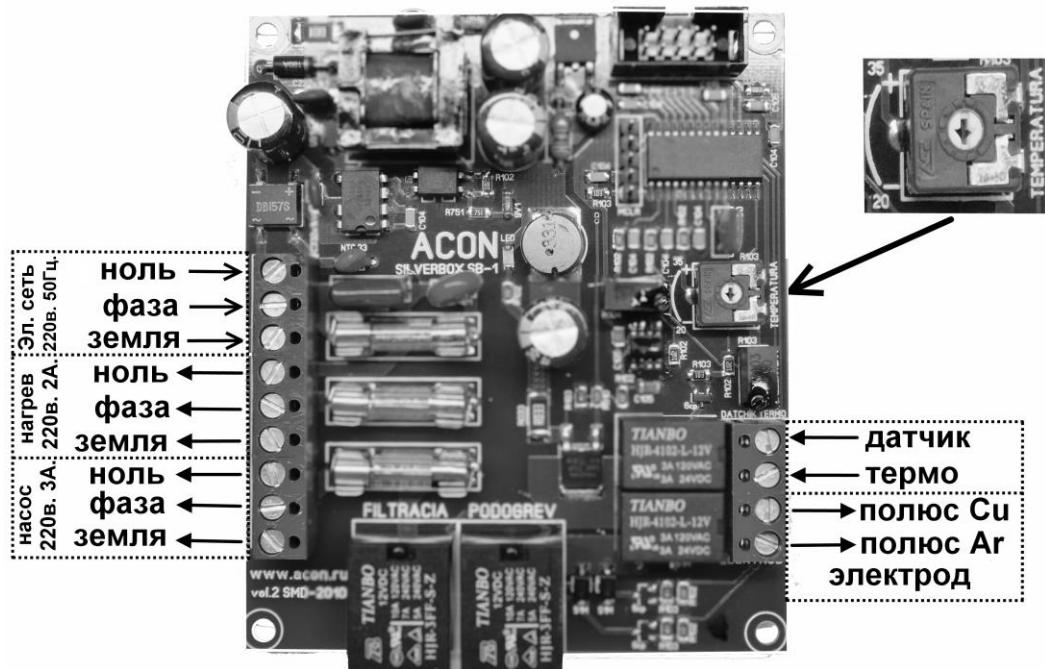
Подключите электрические провода к ПУ как показано на рис. 1.
